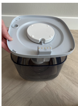
Deksel en filter van de watertank
