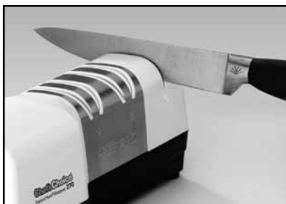
Afbeelding 6. Mes in Fase 3. Maak voor het slijpen heen- en weer bewegingen halen met lichte neerwaartse druk. Zie tekst.
